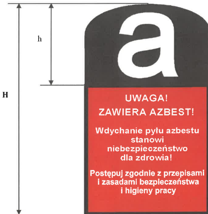
Rysunek 3. Wzór oznakowania wyrobów, odpadów i opakowań zawierających azbest lub wyroby zawierające azbest, a także miejsca ich występowania.
